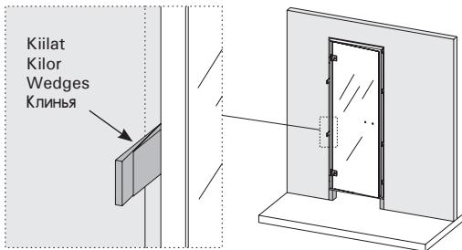
**6.** Kun karmit on kiinnitetty ruuveilla, tarkista vielä että karmit ovat suorassa ja ovi käy hyvin. Tiivistä oven ja seinän väli. Sahaa tarvittaessa kiilat karmien ylittävästä osalta (saha pystyasennossa). Poista alatuut ja karmien tukirima. Asenna listat ja kahva. Säädä lopuksi rullalukko niin löysäksi, ettei ovi lukitu kiinni, kun se ensimmäisen kerran suljetaan.
